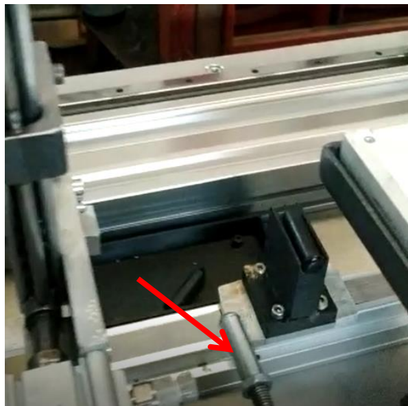
Empujador que desecha el tag RFID defectuosos.
