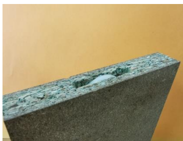
Proceso de inserción del tag modelo 2 en la probeta
